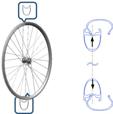
2. Comenzando por el lado opuesto la válvula, instale el otro talón en el canal central de la llanta, trabajando en dirección a la válvula.
