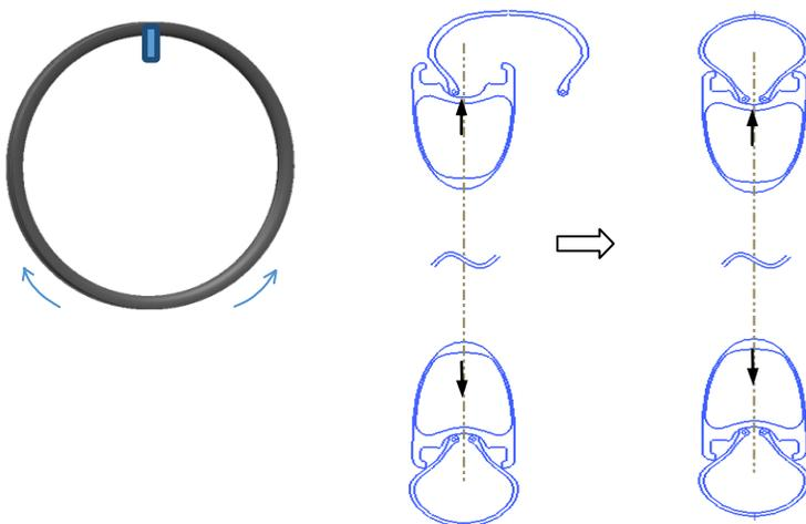
3. Antes de agregar el sellador para neumáticos, infle el neumático hasta que ambos talones se hayan asentado en la llanta. **NO supere la presión de inflado máxima de la llanta o del neumático.** Confirme visualmente que el neumático se ha asentado correctamente en la llanta (la línea de seguridad del neumático y del borde de la llanta debe ser concéntrica).
